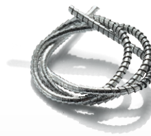
vorher Spanbildung mit herkömmlicher Bearbeitung
