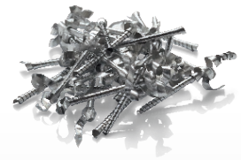
nachher Spanbildung mit High-Frequency-Turning
